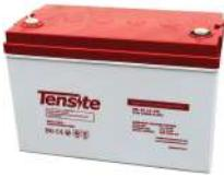
Batería monobloc con tecnología de electrolito en GEL que presenta un formato compacto. Al ser de GEL no emite gases ni requiere de mantenimiento. Es una excelente opción cuando se desea instalar la batería en un sitio sin ventilación. Se recomienda instalar en su posición natural y bajo ninguna circunstancia conectarla en paralelo. Hay que tener en cuenta las tensiones de carga para asegurar la máxima durabilidad de ese modelo de batería....
